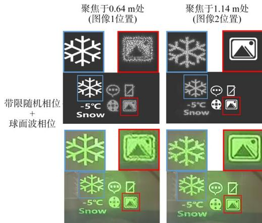
图 7 基于带限随机相位的全息 RPD 在不同聚焦深度的仿真及实验再现图像
